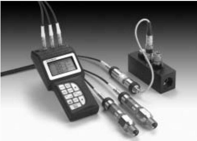
Der **ServiceMaster** ist ein Mehrkanal-Handmessgerät zur gleichzeitigen Messung wichtiger hydraulischer Größen: **Alle hydraulischen Parameter wie Druck, Differenzdruck, Durchfluss und hydraulische Leistungen lassen sich messen, anzeigen, speichern und weiterverarbeiten.**
