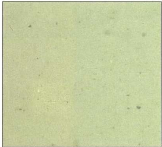
ISO16/14/11 Flüssigkeitszustand (hundertfache Vergrößerung)
